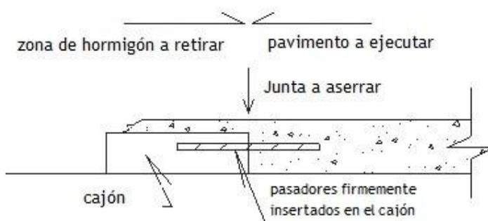
losa. El cajón deberá ser de rigidez tal, que soporte sin deformaciones apreciables, el pasaje de la pavimentadora por sobre él.
